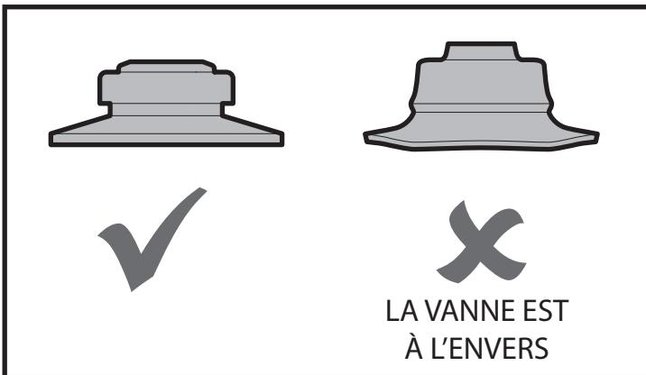
2. Placer la Vanne ③ dans le Bouchon de distribution ④
