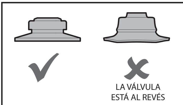
2. Coloque la Válvula ③ en la Tapa dispensadora ④
