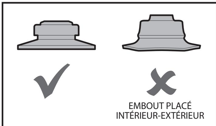
2. Insérez l'**embout** dans le **couvercle**, visser le **couvercle** sur la **cartouche**.
